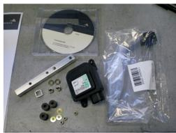
(Abb. 1: Umrüstkit Klappenstellmotor)
