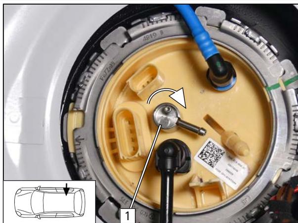
► FuelFix **1** gemäß Abb. ausrichten.
