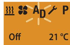
Nach der Anzeige ZUSATZGERÄT OFF wird die Startanzeige angezeigt. Bei Fahrzeugbeleuchtung AUS erlischt die Beleuchtung des Displays nach 10 Sekunden.
