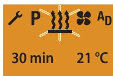
Anzeige bei Luftheizgeräten im Dauerheizbetrieb (Werkseinstellung).
