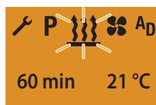
Anzeige bei Luftheizgeräten im Dauerheizbetrieb (Werkseinstellung).
