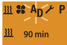
Anzeige bei Luftheizgeräten im Dauerheizbetrieb (Werkseinstellung).
